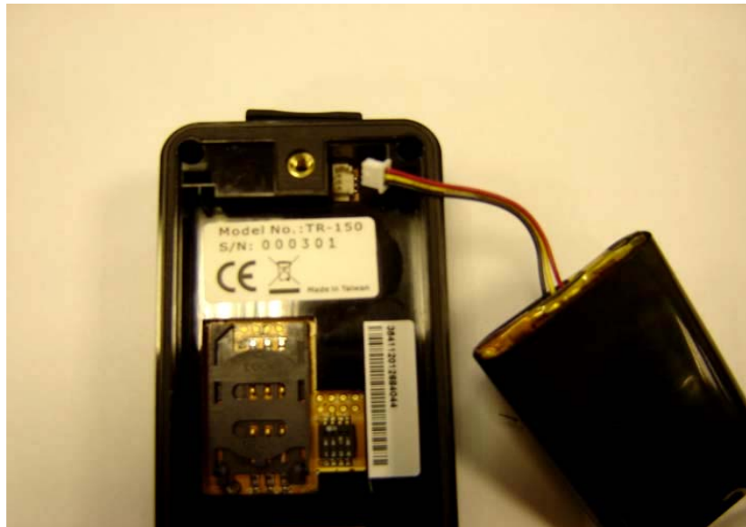
เสียบแบตเตอรี่ให้ด้านที่มีสายสีแดงอยู่ด้านบน
