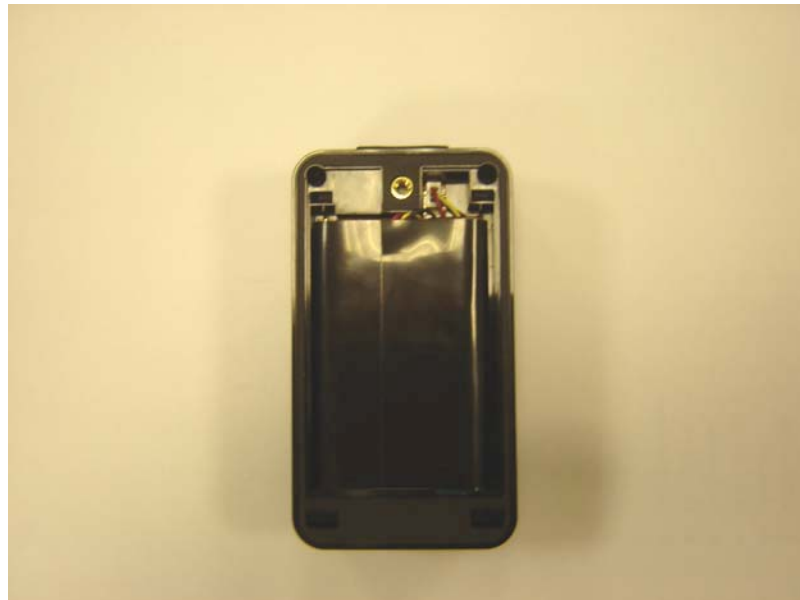
จัดให้สายไฟอยู่ใต้แบตเตอรี่
